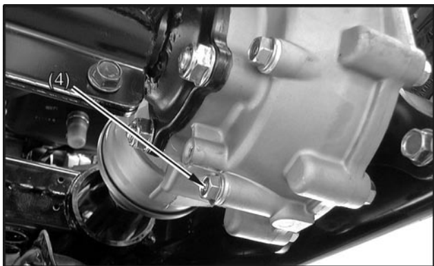
(4) Vite di drenaggio
