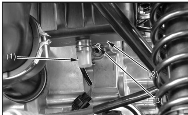
Tubo drenaggio filtro aria
