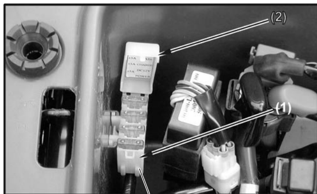
(1) Vano portafusibili (2) Coperchio vano portafusibili
