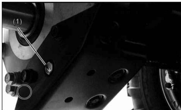
(1) Vite di drenaggio
